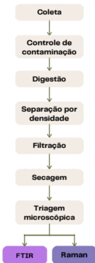
Figura 4 - Fluxograma das etapas do processamento e da análise de microplásticos, desde o preparo da amostra até a identificação espectroscópica.
